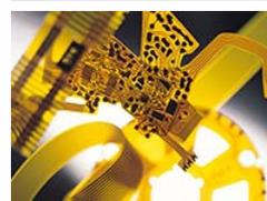
実用化されているプラスチックフィルムでは最高クラスである耐熱性（400℃）と耐寒性（-180℃）を誇る高機能性フィルム
