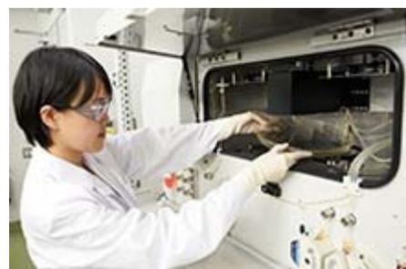
安全・安心・簡便に培養を行える「自動細胞培養装置」
