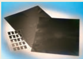
高い熱伝導率を有し、電子機器の熱拡散材料として期待されるグラファイトシート
