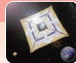
アビカル® (超耐熱性ポリイミドフィルム) は、宇宙ヨット「IKAROS」の帆に採用されました (写真提供：宇宙航空研究開発機構 (JAXA))
