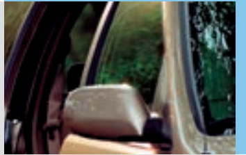
ハイパーライト® (射出成形用エンジニアリング樹脂)： 従来の耐熱PET樹脂に加え、自動車外装部 品向けPC/PET系樹脂で軽量化を実現しま した。
