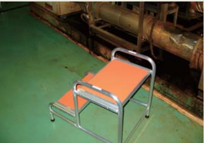
これまで脚立の天板に乗り作業をしていたところを、専用の作業台を購入し設置しました
