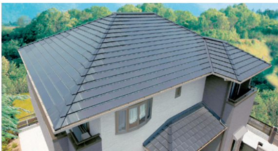
美しい屋根をコンセプトにした「瓦一体型太陽電池」
