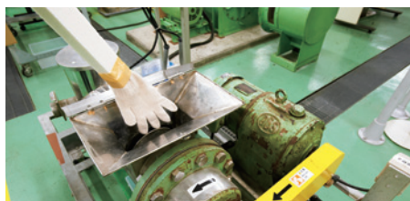
軍手を付けた腕の模型を使用することでよりリアルに事故の危険性を伝えている
